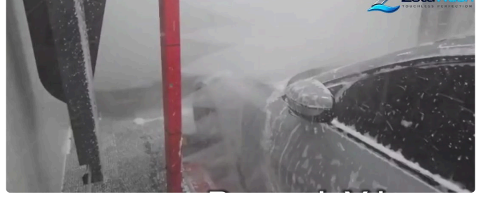
130 bar basınçlı durulama, lazer sensörle araç konturu takip edilir.
